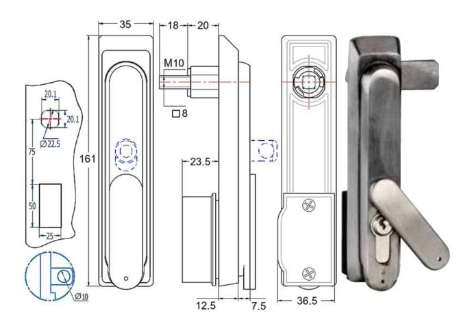
Poignée escamotable en acier inoxydable (AISI 303) verrouillée par demi-cylindre. Différents cylindres disponibles :
